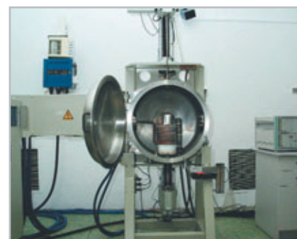
Komora Oxypuller 05-03 z ITME, gdzie w temperaturze dochodzącej do 2000 stopni Celsjusza uzyskuje się metodą CZOCHRALSKIEGO kryształy tlenków.
