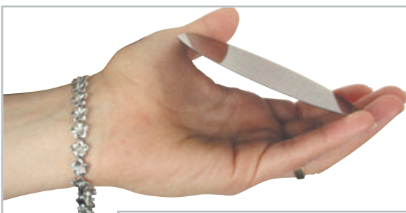
OLBRZYMI MONOKRYSTAŁ KRZEMU tnie się na cienkie plastry, które po oszlifowaniu służą do produkcji wszelkich układów elektronicznych.
