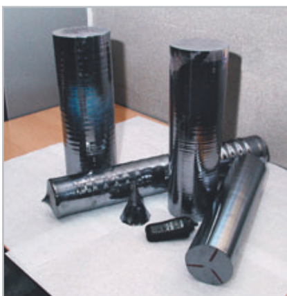
Mierząca prawie PÓLTORA METRA długości i 20 cm średnicy bryła krzemu jest jednym gigantycznym kryształem.
