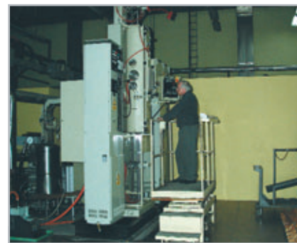
Urządzenie do BEZTYGLOWEJ PRODUKCJI MONOKRYSTAŁÓW stanowi alternatywę dla metody Czochralskiego, ale pozwala uzyskać znacznie mniejsze kryształy.
