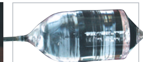
Uzyskany w KOMBORZE OXYPULLER szafir może posłużyć np. jako podłoże do budowy niebieskiego lasera.
