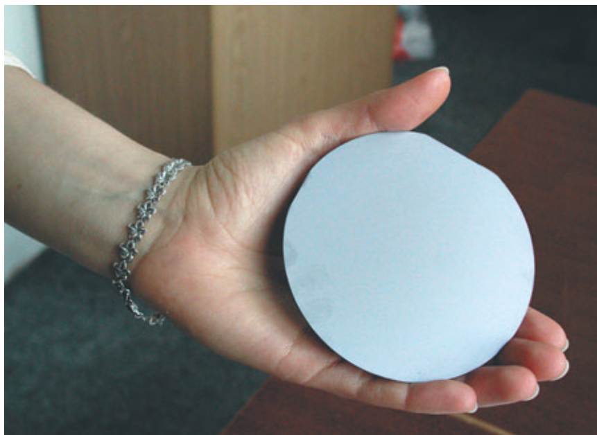
Uzyskany w KOMBORZE OXYPULLER szafir może posłużyć np. jako podłoże do budowy niebieskiego lasera.
